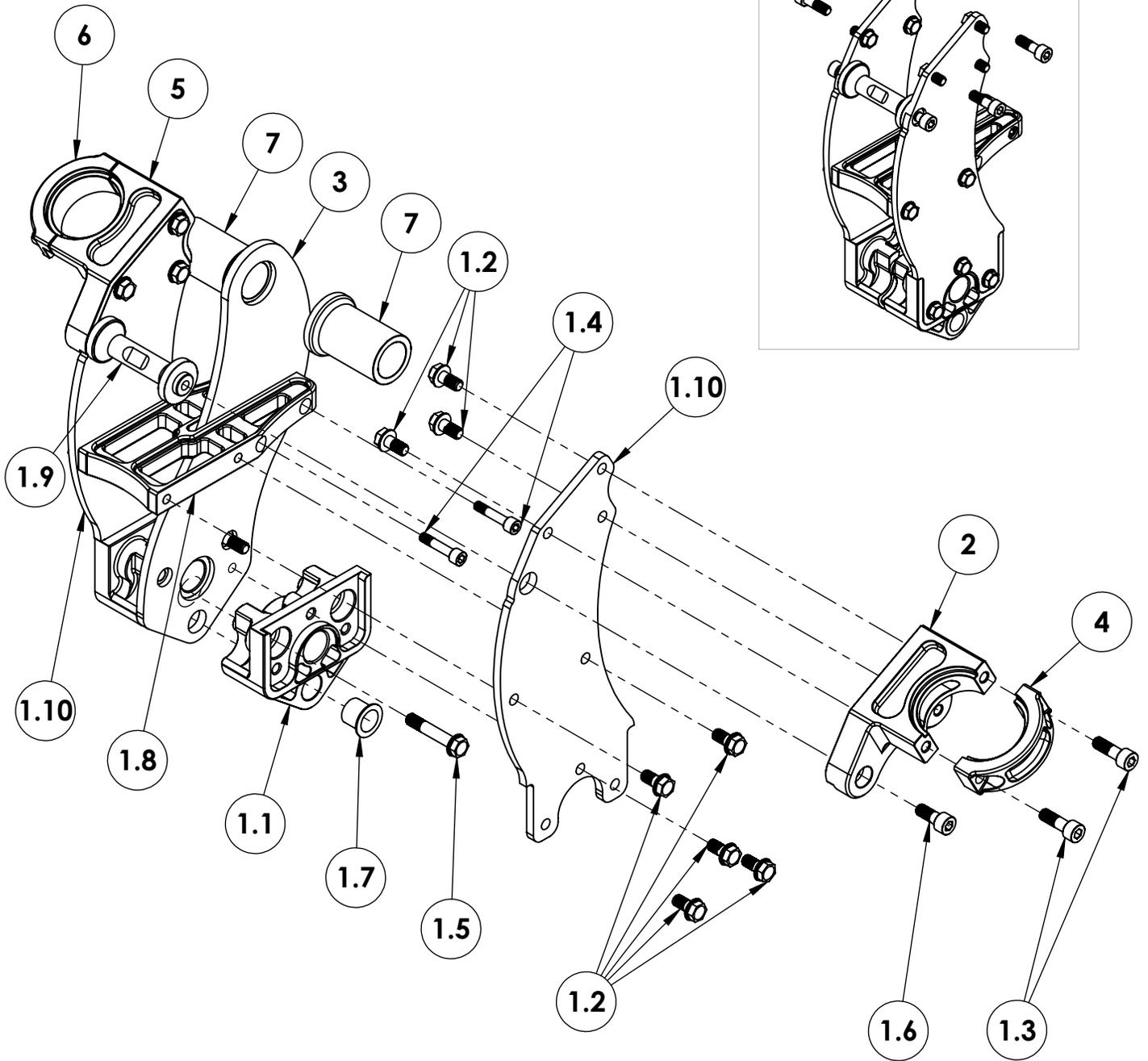
**2017 SPINDLE ASSEMBLY, 35MM OFFSET, 48MM DROP, 48MM FORK, 190MM CL**
